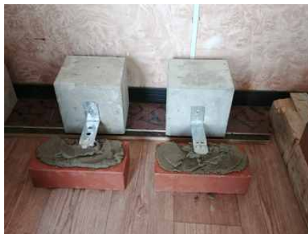
[그림 3-12] L형 연결철물부 시험체 제작
