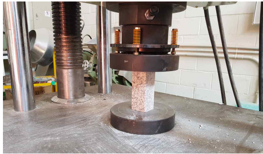
[그림 4-5] 석재 압축강도 시험
