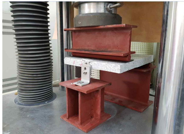
[그림 4-7] 석재패널-꽃음축 접합부 시험
