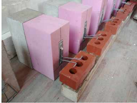
[그림 3-13] C형 연결철물부 시험체 제작
