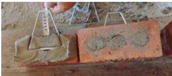
[그림 3-8] 연결철물-모르타르 부착실험 실험체 제작
